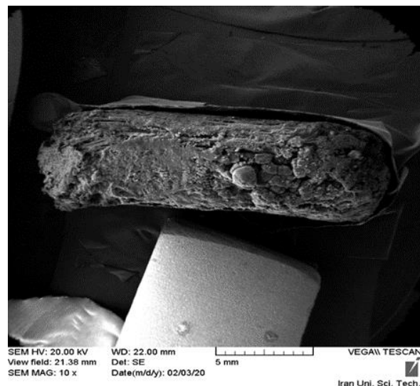
شکل ۵- تصویر SEM از سطح مقطع جانبی نمونه بعد از تست فرسایش
