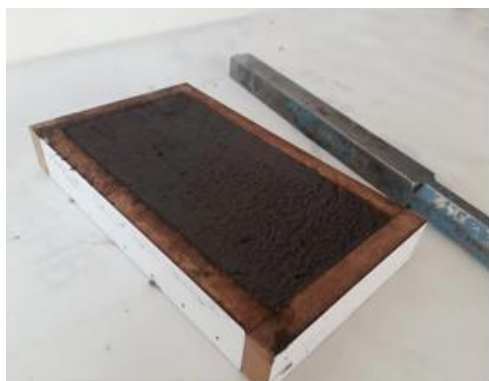
شکل ۳- آزمون‌های مکعبی بتن ژئوپلیمری (راست) و آجرنمای ژئوپلیمری قالب‌گیری شده (چپ)
