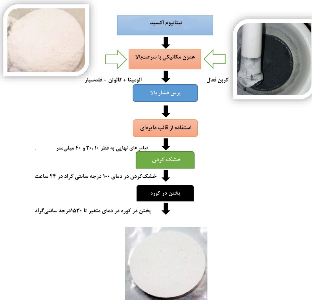
شکل ۳- شماتیک مراحل ساخت فیلترهای کامپوزیت پایه سرامیکی
